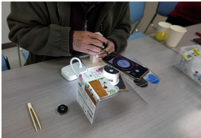
透過光照明法で薄い試料（植物プレパラート）を観察し、スマホに映し出す
