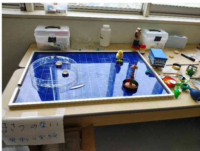
微小ビーズを用いる摩擦のない装置 を使った運動の実験コーナー
