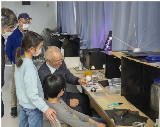
点光源が作る影を用いて、見えない白色 電球の中のフィラメントを見る実験
