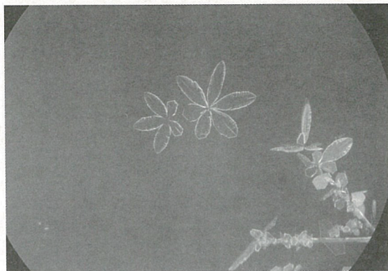
写真8：塩化ビニールの板の上に見える人工雪
