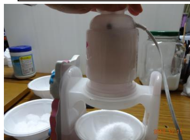
手でおすとモーターが回転し氷がけずれる
