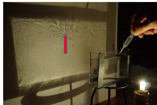
水とアルコールが混（ま）じる様子がスクリーンに映し出されます。
