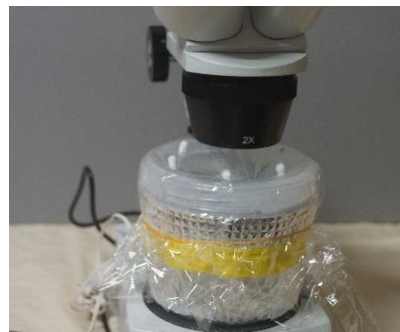
実体顕微鏡の下で人工雪を作る
