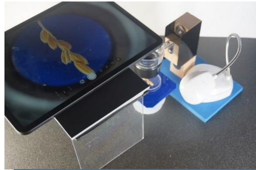
タブレット台に i-Pad を置き撮影 (試料はモミ)
