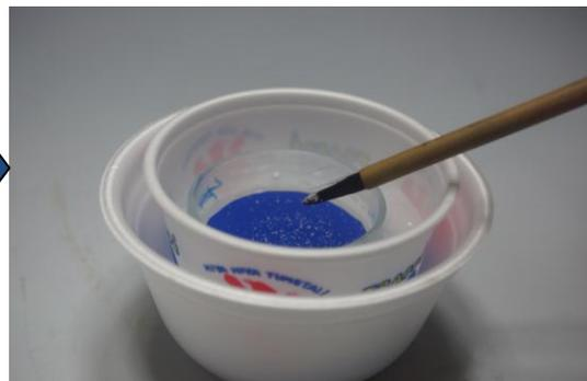
冷やした小筆で、雪を雪採集装置から観察装置に移します
