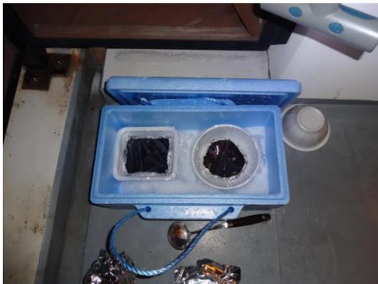
保冷ボックスの中に雪採集装置を入れ、雪を集めたら蓋をして持ち帰る。
