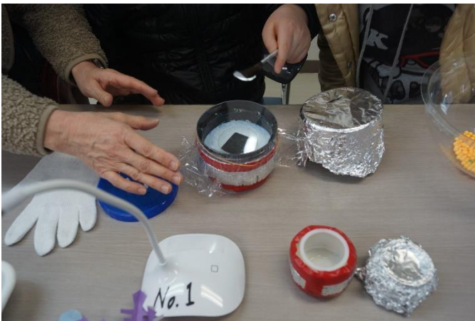
人工雪生成容器の蓋をとると基板の表面が結晶で光っている
