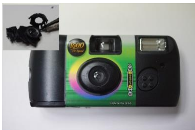
ラジオペンチではがし、レン ズを取り外す
