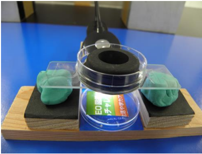
小学生用水レンズ顕微鏡 (照明は100円ショップ で購入のクリップLED)
