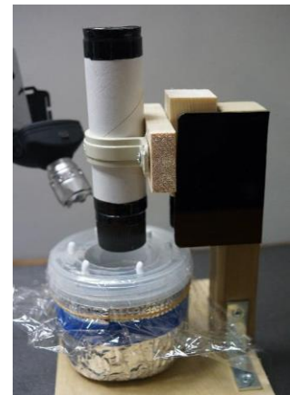
容器の中で基板上に成 長する人工雪が観察で きる
