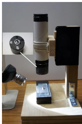
ボタン型マグネットを木のブ ロックに埋こみ、支柱に取り 付けた鉄板との間に働く磁力 で上下にスライドさせる
