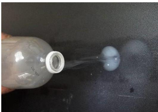
小型空気砲を打ち出して煙の渦を見る
